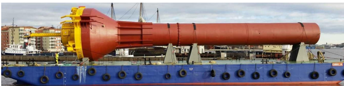
Figur 8: WaveEL før den er installert, den røde delen går under overflaten og den gule delen flyter [13].
