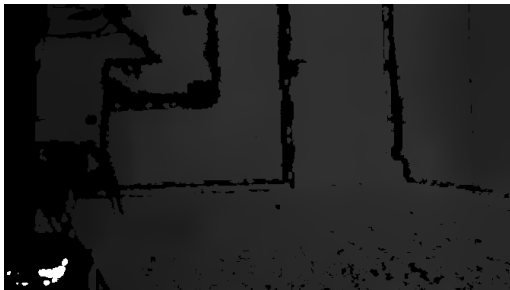
(a) Dybdebilde fra stereokamera konvertert fra 32 bit/piksel til 8 bit/piksel gråskala-bilde.
