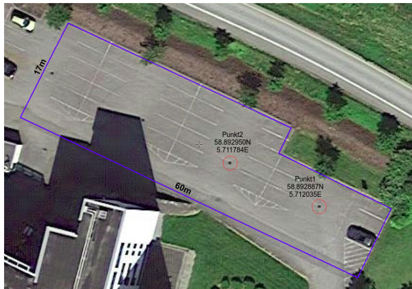
Figur 51: Referansepunkt benyttet i tester for global posisjonering (vannavløp).
