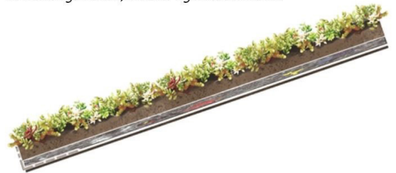
Snitt skråtak (6-20 grader) med avslutningslist. Oppbyggingen viser rotsikker membran, filtduk og sedummatte.
