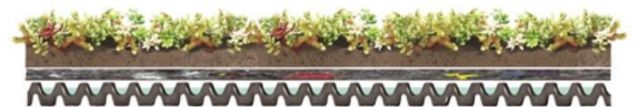
Snitt flatt tak (0-6 grader) med avslutningslist. Oppbyggingen viser rotsikker membran, dreneringsmatte, filtduk og sedummatte.
