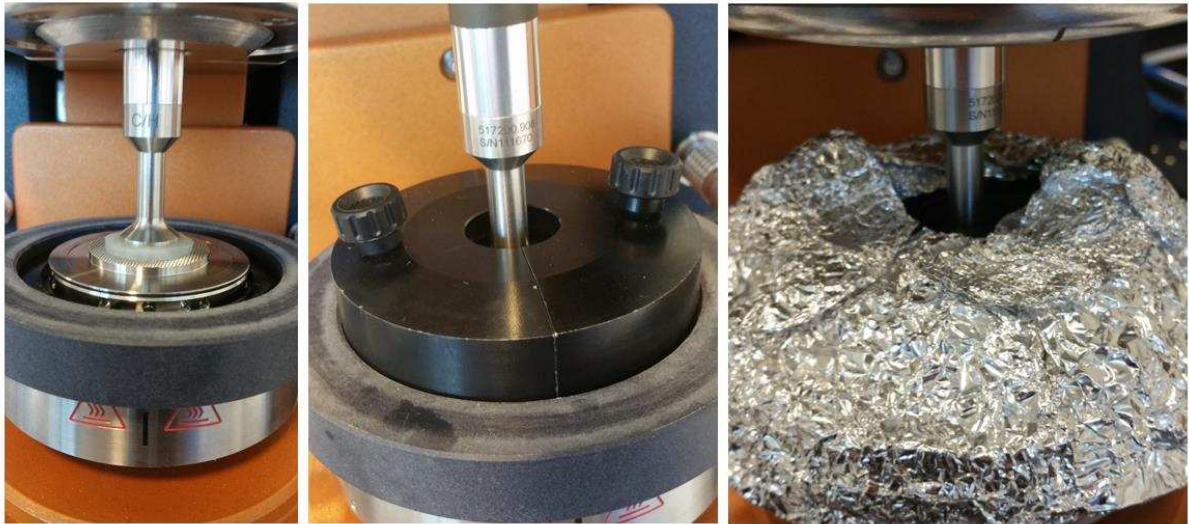
Figur 3.5: Reometer og oppsett for analyse. Venstre: tint prøve ble overført til peltierplaten og geometrien ble senket. Midten: avkjølt fordampingsfelle ble plassert over prøve, peltierplaten og geometri. Høyre: et lag med aluminiumsfolie ble plassert over fordampingsfellen, uten å berøre geometrien.
