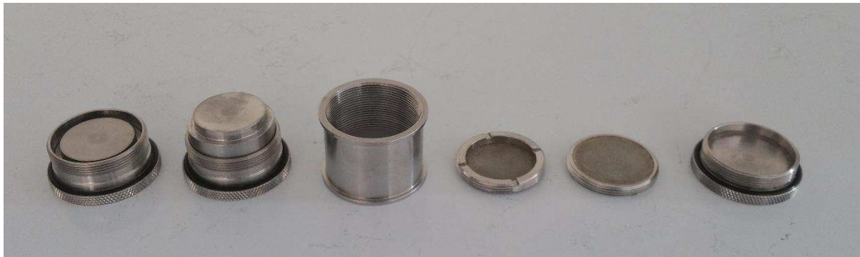
Figur 3.4: Analysekopper for måling av vannbindingsevne. Fra venstre viser bunnsposisjon under sentrifugering, bunnsposisjon under varmebehandling, prøve kopp, bunnsiden av filter, toppsiden av filter og toppblokk.
