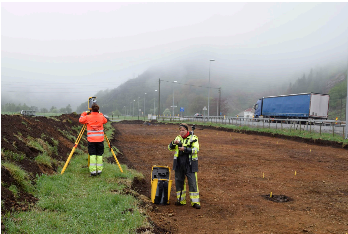
Figur 6: Guro Rolandsen setter opp totalstasjon og Karoline Mikkelsen forbereder innmålingen av de merkede og opprensede strukturer i sjakt 4. Tatt mot V
