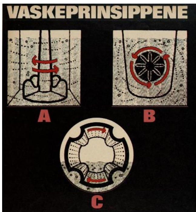
Figur 7 Ulike vaskeprinsipper i automatiske vaskemaskiner. Hentet fra Forbrukerrapporten 1957, nr. 8, s. 32
