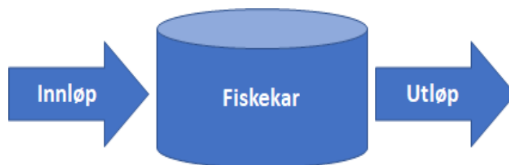
Figur 5: Forenklet illustrasjon av gjennomstrømningsteknologien
