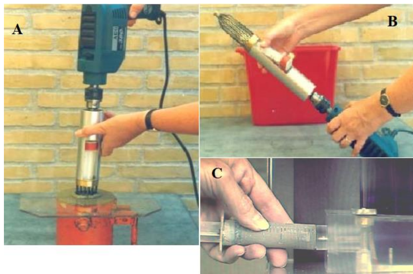
Figur 3.7.2: A: Prøveuttak. B: Montering av vibratoren med sprøyte. C: Prøven settes inn i beholderen (AVA-3000). [6]
