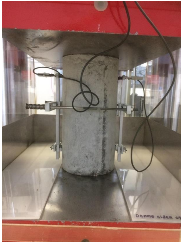
Figur 5 - Prøvestykke i test E-modul
