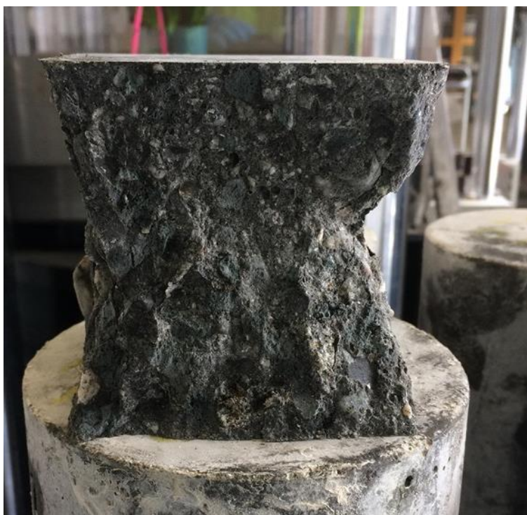
Figur 14 - Terning etter brudd trykktest
