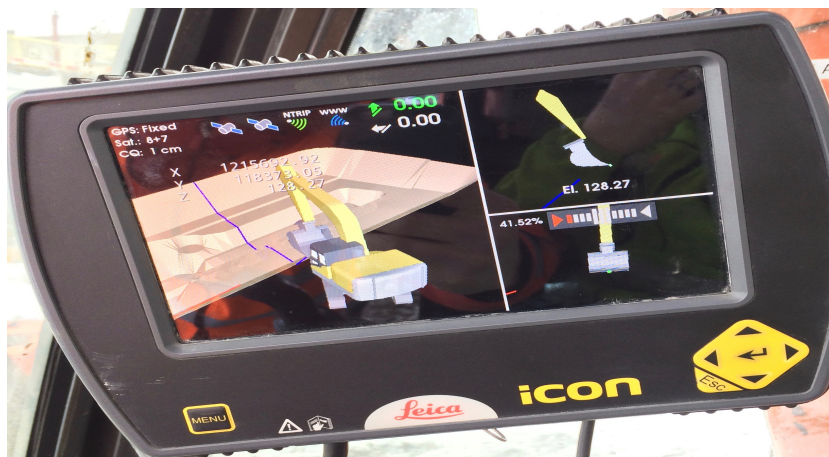
Figur 5.11: Visuell fremstilling av trau i maskinstyringen
