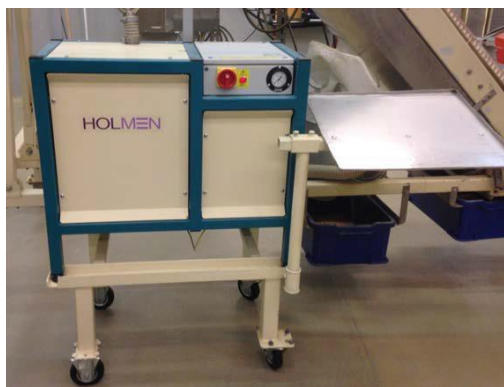
figur 2-19 HOLMEN tester NHP 300 som ble benyttet i dette prosjektet
