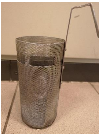
figur 3-2 prøveholder for å veie 1 liter pellet for å avgjøre volumvekten
