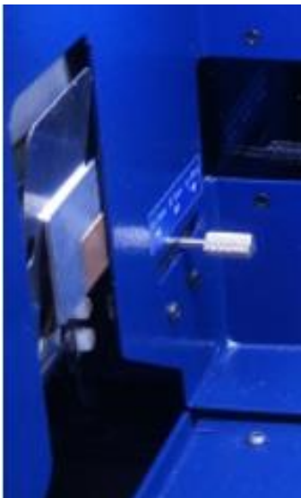
figur 2-14 Viser 1 mm tykt aluminiumfilter plassert foran ccd kamera.
