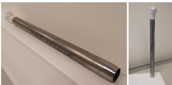
figur 4-8 Bilde av stålrøret som skjærer ut isoporplatene i lik diameter.
