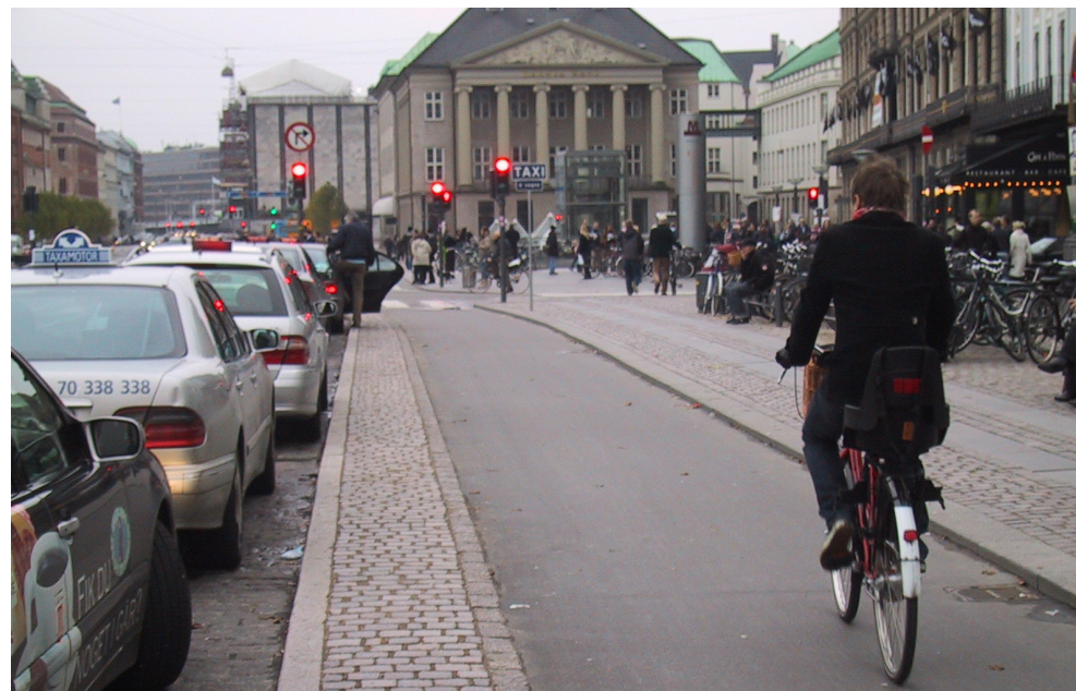
Figur 14 : Eksempel på "Hybrid cycle lanes" i Danmark, (Cycling Emabasy of Denmark, u.å)
