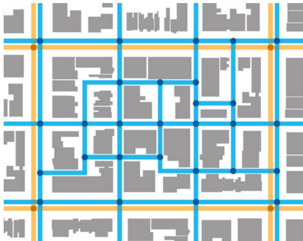
Figur 11 : Her vises et eksempel på en gatestruktur hvor gangforbindelsene (blå) gir flere alternative kryssninger og dermed bedre tilgang. Bilen(orange) blir plassert ytterst i strukturen og får en dårligere tilgang(Maimunah Mohd. Sharif, 2018).
