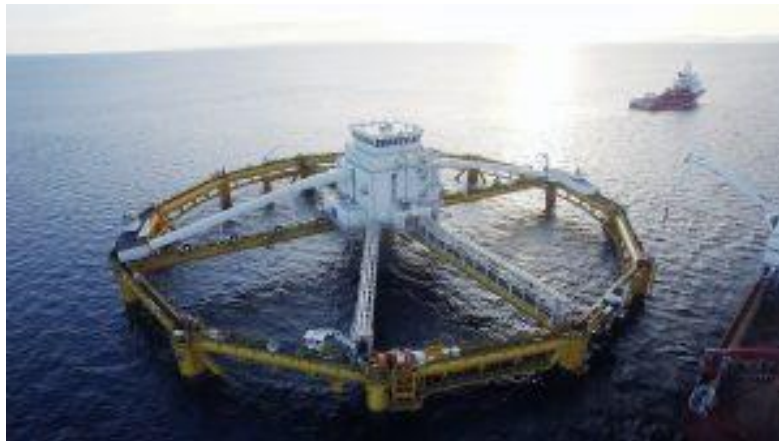
Figur 13: Offshoreløsning for oppdrett fra Salmar utenfor Frøya (Espmark, 2019)
