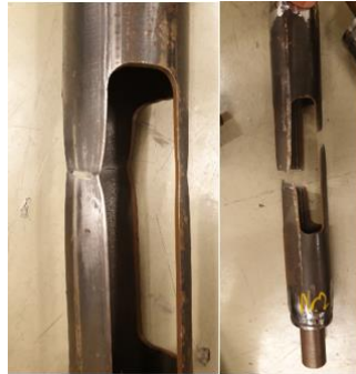
Figure 44 Tensile test of 60,5 mm x 3,7 mm pipe
