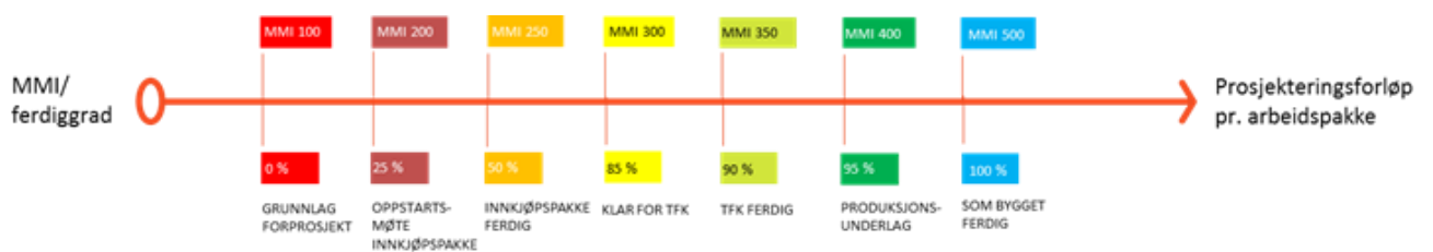
Figur 22: MMI-statuskoder med prosent fremdrift hentet fra prosjektet PNB
