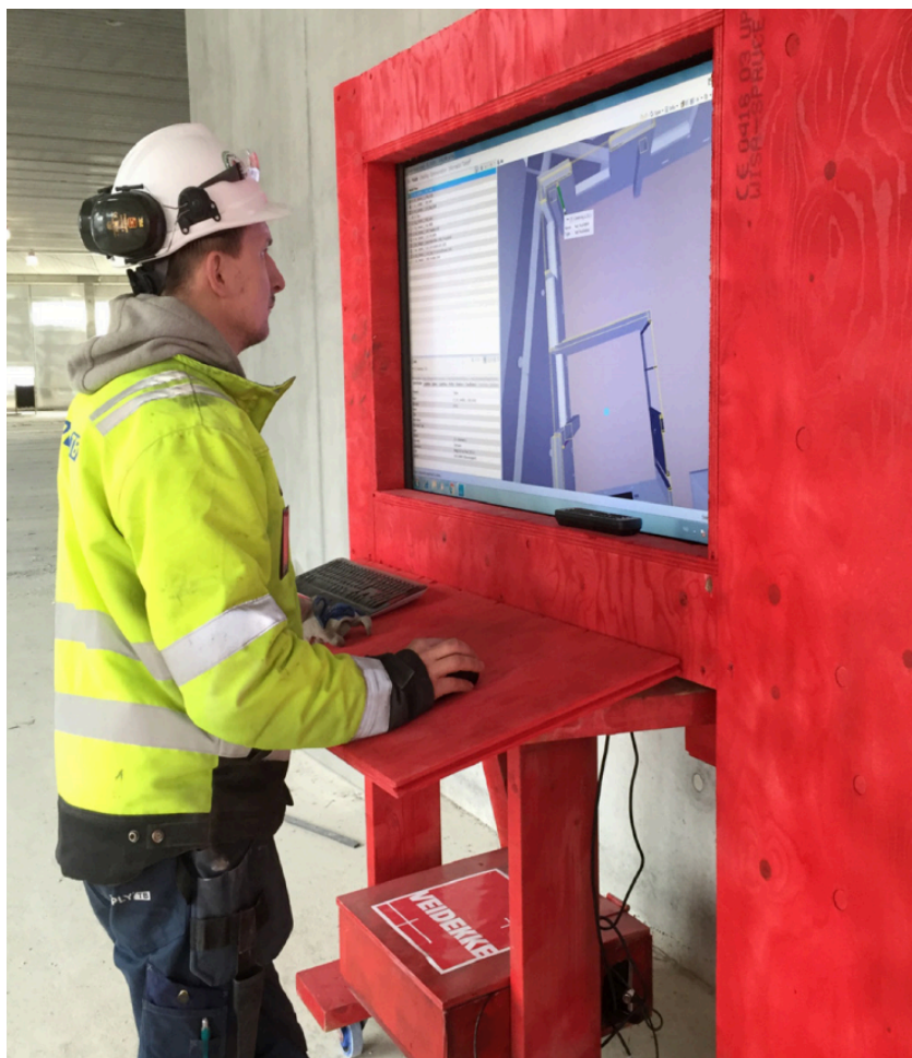
Figur 4.6 BIM-kiosk bygget i en innkassing montert på hjul (Statsbygg & KHiB team, 2018)
