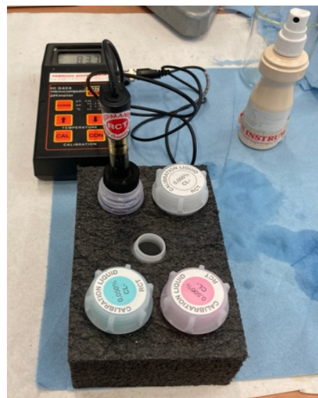
Figur 10 - Kalibrering med kalibreringsvæsker
