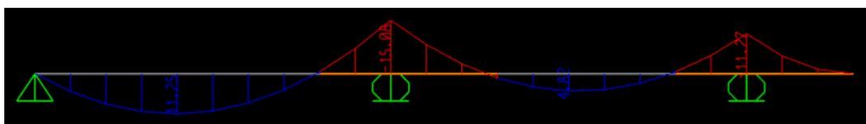
Figur 24 - Momentdiagram etasjeskille (SAP2000)
