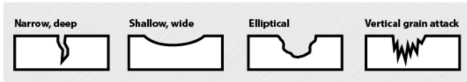
Figur 37: De forskjellige typene for punktkorrosjon (pitting) [19]
