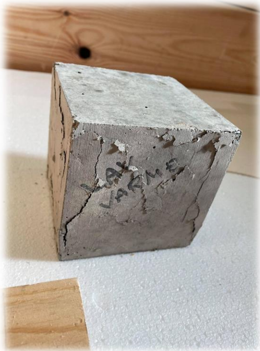
Brudd etter en trykktest av Lavvarme sement #1
