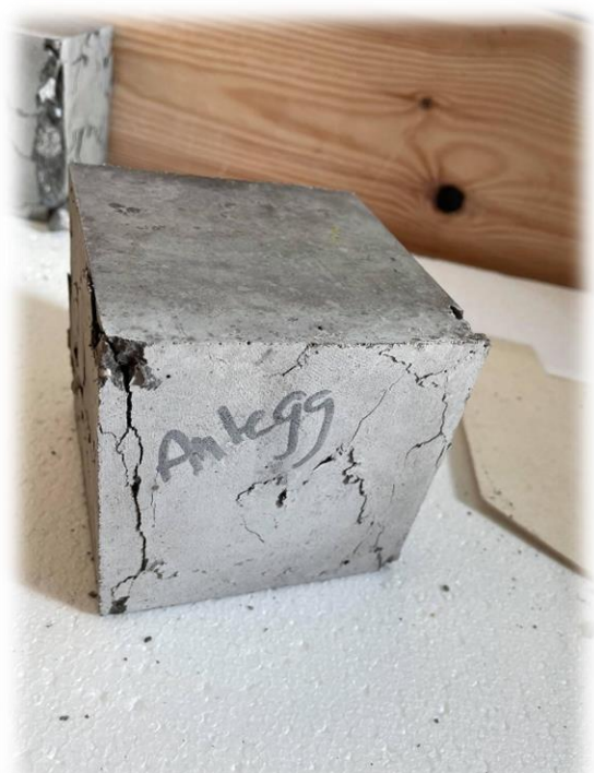
Brudd etter en trykktest av Anlegg sement #2
