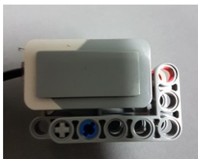
Figur 5.6: Lyssensoren med avstandklosser fra venstre side.
