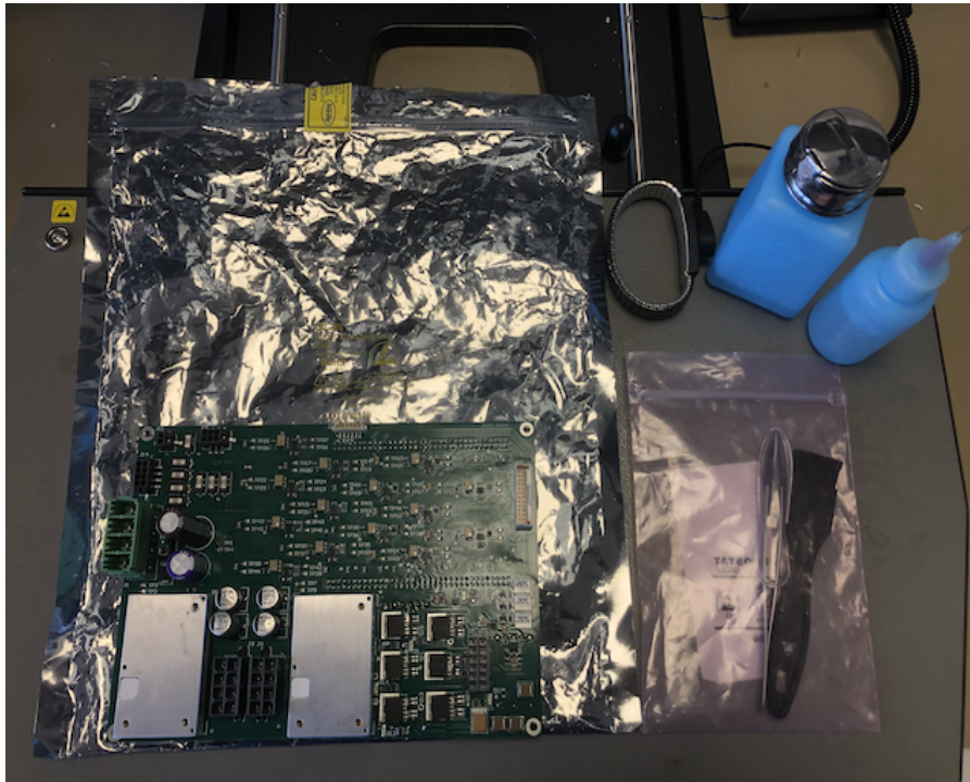
Figur 8.47: Bilde av utstyret som ble brukt for å beskytte kortet for elektrostatisk utladning.
