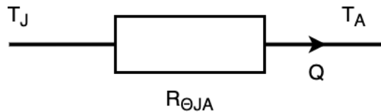
Figur 7.7: Termisk oppsett ved stasjonære forhold av transistoren.
