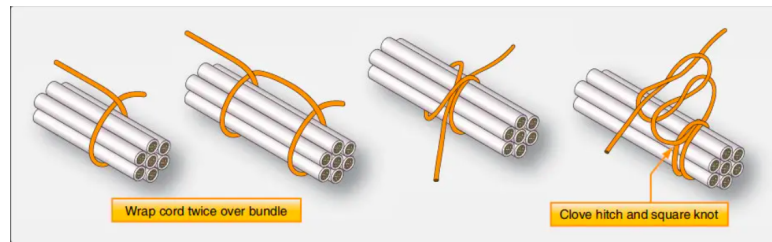
Figur 3.19: Illustrasjon av metoder å bruke bendsletråd på kabelbunter [35].
