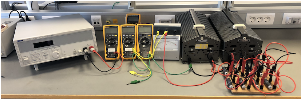
Figur 10.14: Testutstyr for å teste strømsikringene på kraftfordelingskortet.
