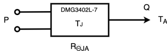
Figur 7.11: Termisk oppsett av transistoren DMG3402L-7.
