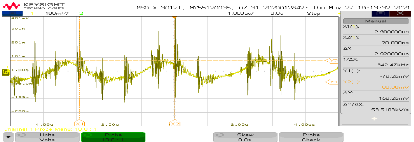
Figur 10.5: Rippelspenning på utgangen til spenningsregulatoren U_2 , ved bruk av dempningsforhold x10 på oscilloskopproben. Innstillinger på oscilloskopet: 100 mV/div og 1 \mu s/div
