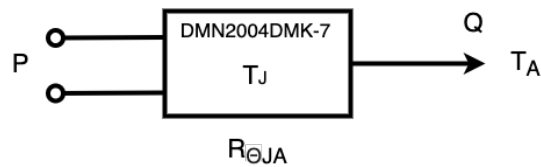
Figur 7.6: Termisk oppsett av transistoren DMN2004DMK-7.
