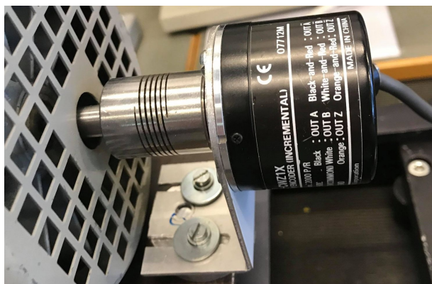
Figur 2.15: Bilde av enkoderen montert på motoren.
