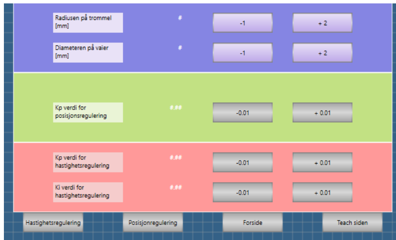
Figur 4.1: Skjermen til forsiden, hvor radius til trommelen og diameter til vaieren blir skrevet inn, i tillegg til reguleringsparametere.
