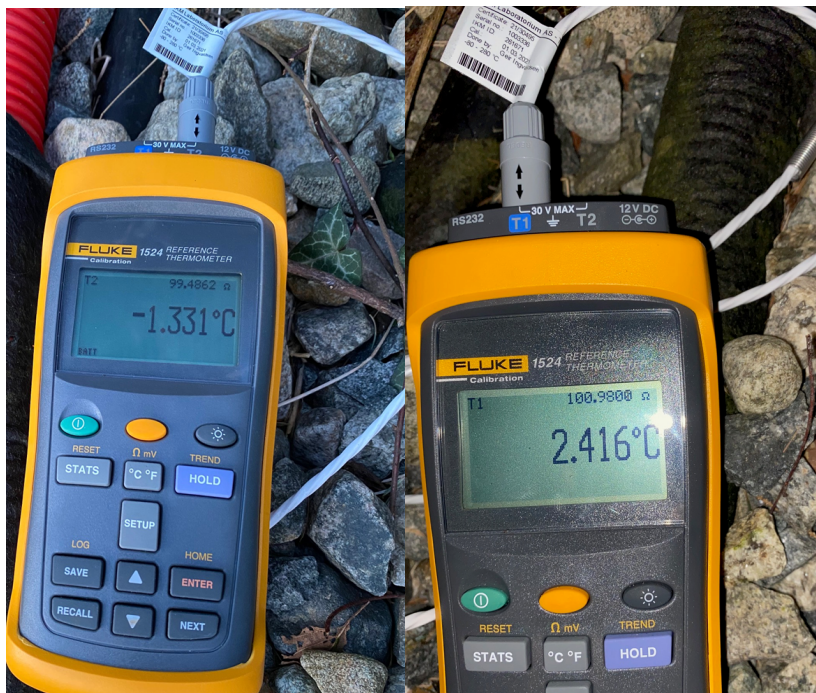
Figur 4-15 Temperaturkalibrering – Fluke 5615 med nøyaktighet \pm 0.021^{\circ}\text{C}
