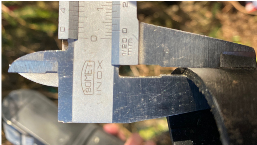
Figur 4-11 Verifisering av kuldebærer volum
