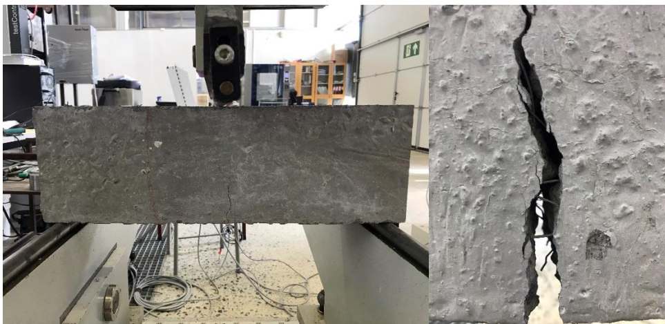
Figur 7.7: Prøving av bøyestrekfasthet
