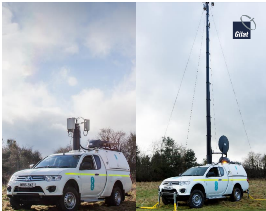
Figur 22: Bilde av mobil basestasjon med bruk satellitt som en del av transportnettverket. (Oren, 2020)
