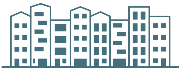
Figur 6.16: Eksempel på hvordan en fasade kan deles opp for at den kan oppleves som kortere og mer interessant.
