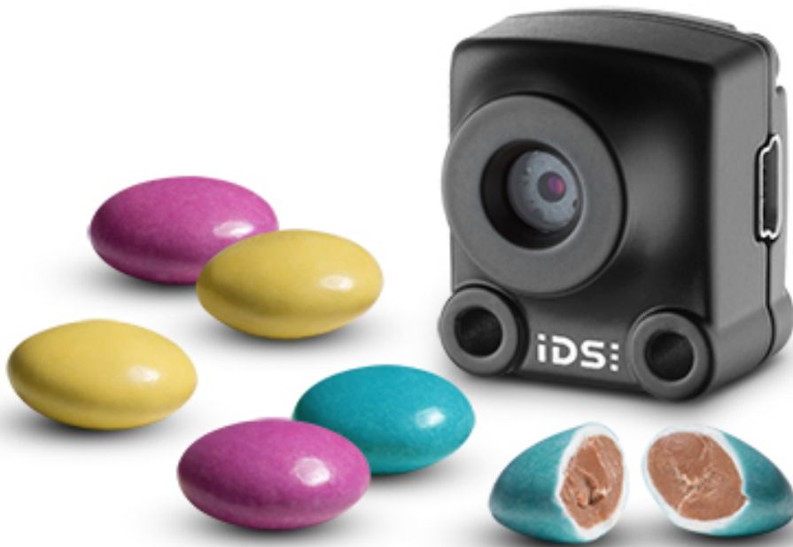
Figur 3.1: \mu Eye2 utviklet av IDS her sammen med M-sjokolade for å illustrere den lille størrelsen på kameraet. Bilde er hentet fra http://en.ids-imaging.com/
