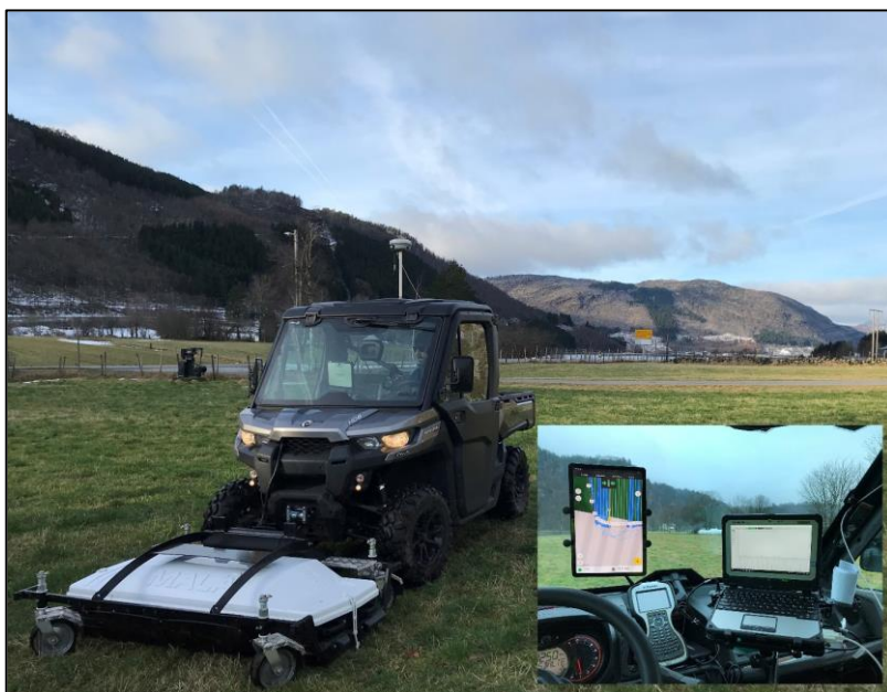
Figur 5: Utstyret som ble brukt på undersøkelsene. Malå Mira montert foran på en firehjuling (Foto: AM, UiS).
