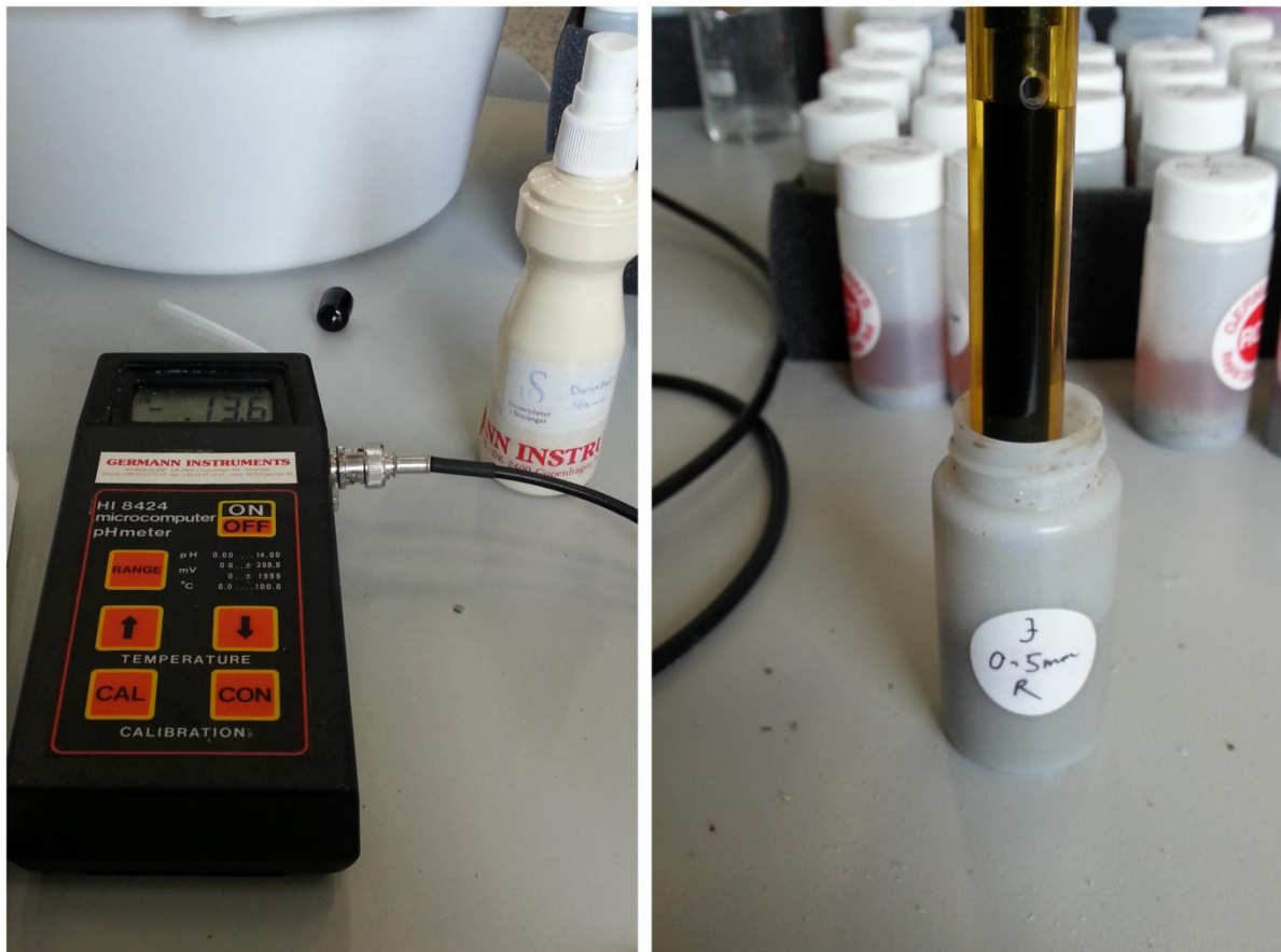
Figur 20: Måling av spenning i betongstøv.
