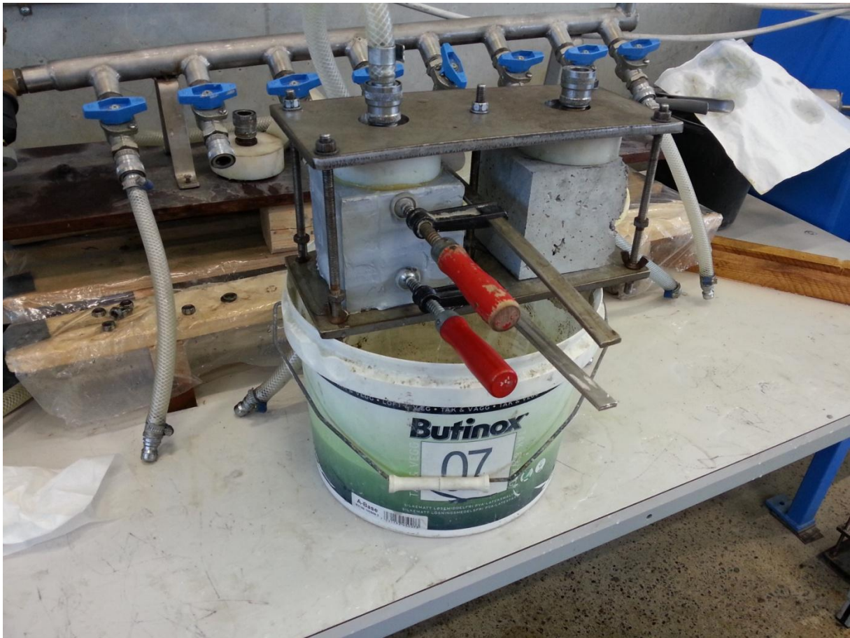
Figur 22: Måling av vanngjennomtrengning.
