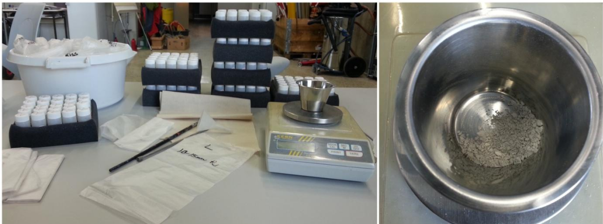
Figur 19: Oppmåling av betongstøv til ampuller med ekstraksjonsvæske.
