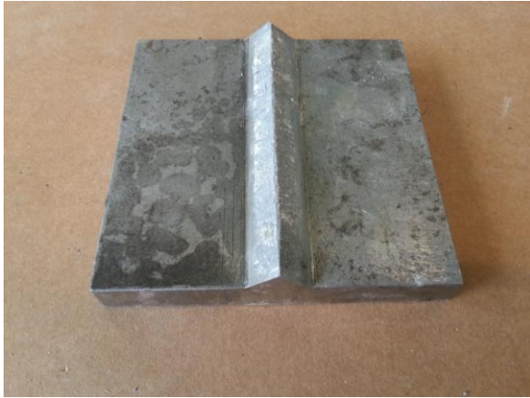
Figur 14: Kløyveverktøy for å lage riss.
