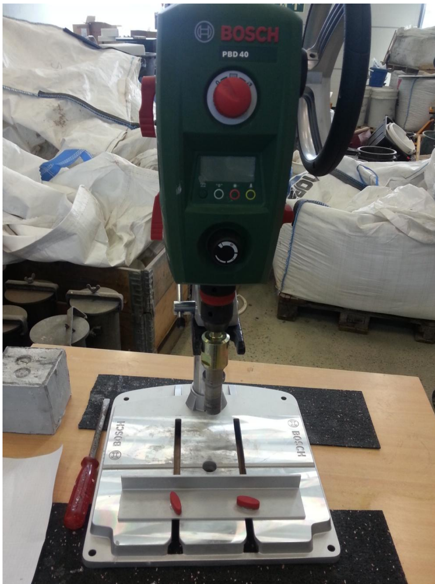
Figur 18: Utstyr til utboring av betongstøv.
