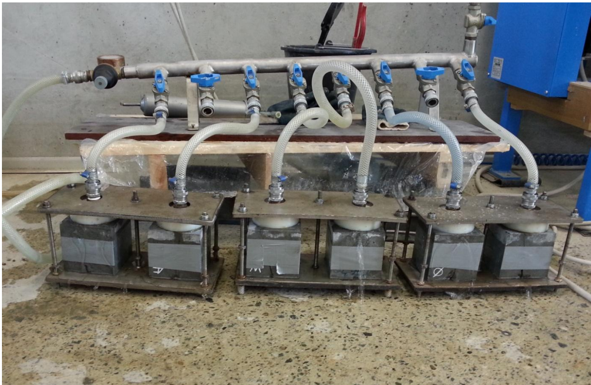
Figur 25: Forsøk på å måle vannpermeabilitet.
