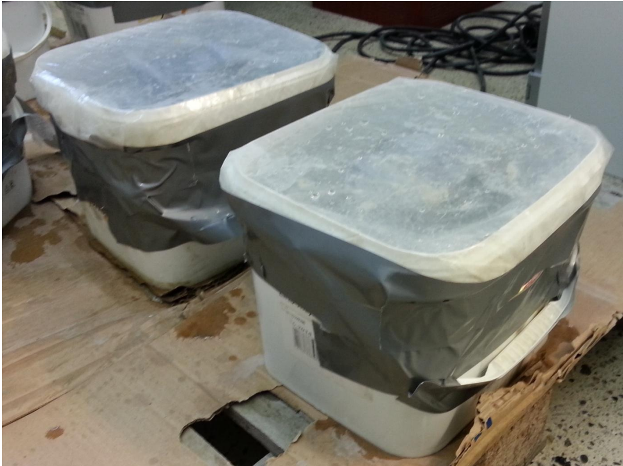
Figur 23: Beholdere med prøvestykker i en løsning av \text{Ca}(\text{OH})_2 .
