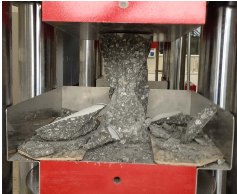
FIGUR 33: SYLINDER SOM EKSPLODERTE UNDER ARBEIDSDIAGRAMTEST
