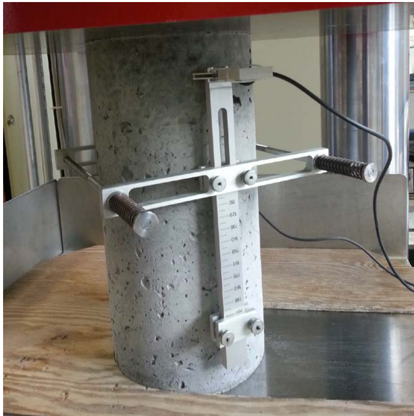
FIGUR 21: PRØVESTYKKE MED EXTENSOMETER FOR MÅLING AV LENGDEFORANDRING
