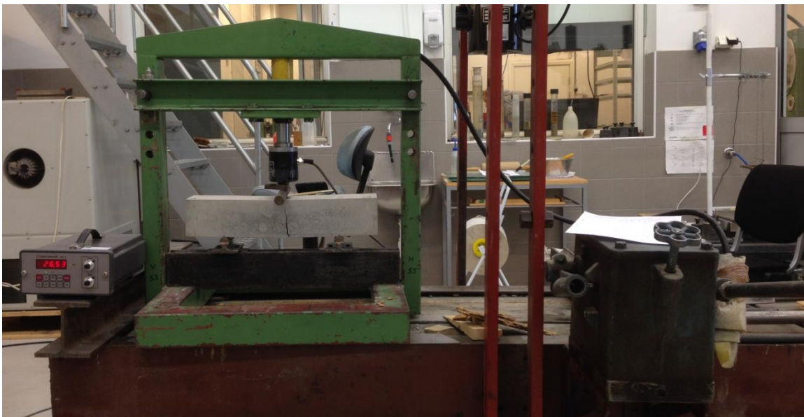
Figur 7-17: Jigg for testing av bøyestrekfasthet.
