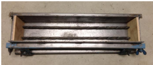
Figur 7-5: Støpeform med innlagte basaltstenger.
