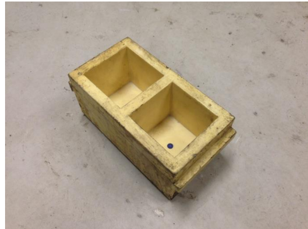
Figur 7-3: Til venstre: Nominelle størrelser på terninger. Til høyre: Støpeform for terninger.
