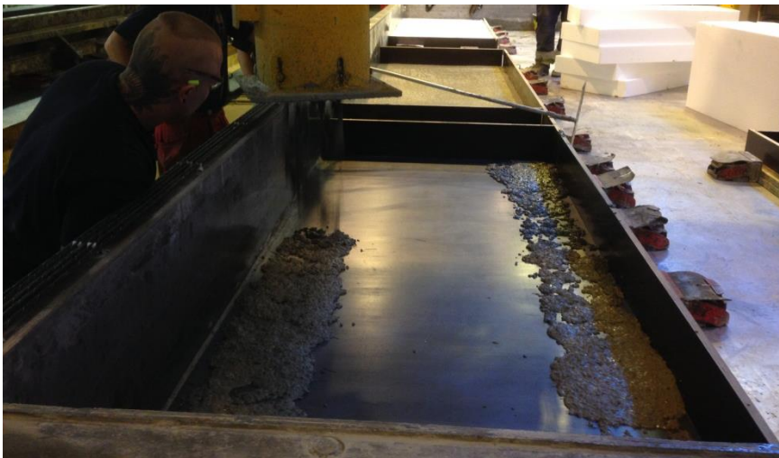
Figur 7-12: Støpeformer for fullskalaelementer med målene 3m x 1,2m.
