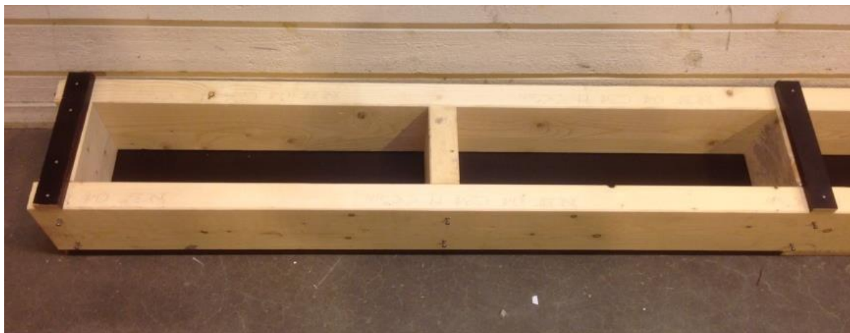
Figur 7-7: Støpeform for store bjelker.
