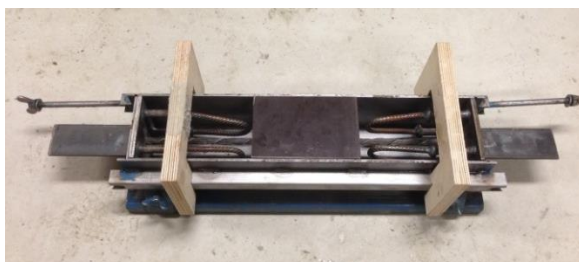
Figur 7-10: Støpeform for innsnevret bjelke med 1 stk. \varnothing 9\text{mm} basaltstang.
