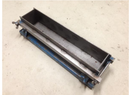
Figur 7-4: Til venstre: Nominelle størrelser på bjelker. Til høyre: Støpeform for små bjelker.
