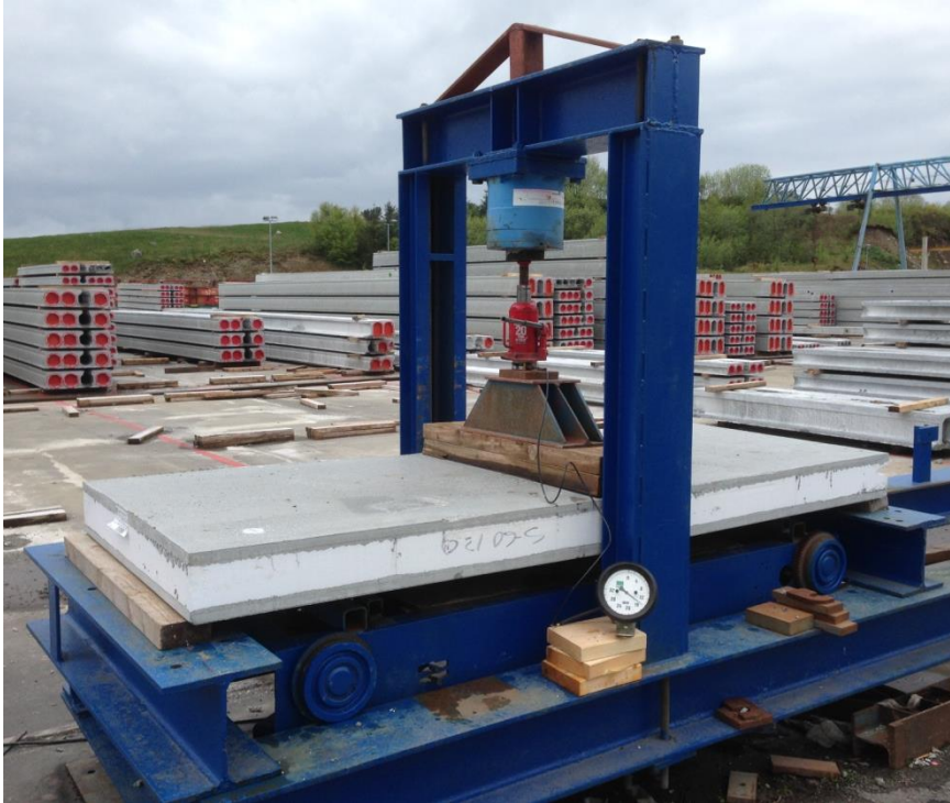
Figur 7-25: Jigg for testing av fullskalaelementer.
