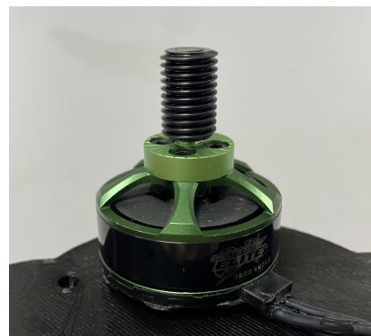
(b) Viser vanntettet Multistar Elite 3508.
