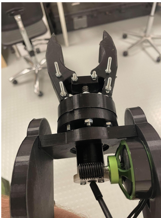
Figur 5.4: Bildet viser den grønne BLDC-motoren på høyresiden som er koblet til et ormgir. Bildet viser også klypen sett ovenfra.
