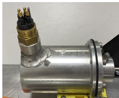
(b) Viser Nema 17 med vanntett kapsel.
