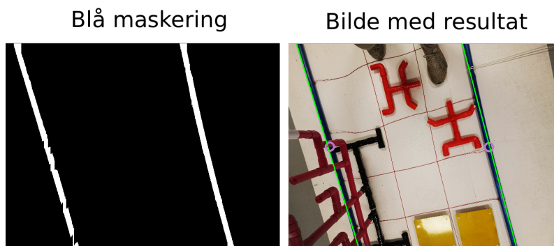
Figur 78: Eksempel 6. Dette er et eksempel på en situasjon hvor ROV-en har rotert mye. Det er også mulig å observere hvordan korallrevet kutter det venstre blå røret opp. Røret blir koblet sammen ved hjelp av morfologisk lukking (seksjon 3.5.4). Rotasjon: 15.9^\circ Forskyvning: 0.10[m] Stoppsignal: Nei
