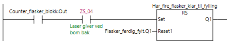
Figur 3.15: Utdrag av kode. Har-fire-flasker-klar-til-fylling er tilstanden som starter fyllesekvensen.
