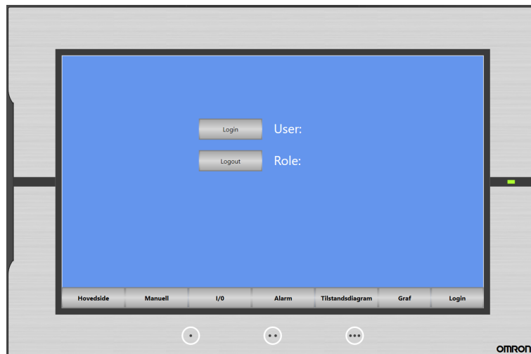
Figur 4.26: Innlogging for å få økt tilgang til systemet. Når en administrativ bruker har logget seg inn vil det komme en ekstra knapp på I/O-siden hvor veiecellen kan kalibreres.
