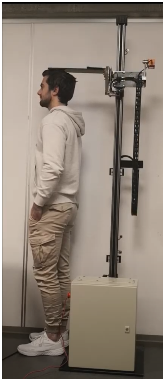
Figur 5.1: I figuren vises heismodellen når en person bruker den for å måle høyde.
