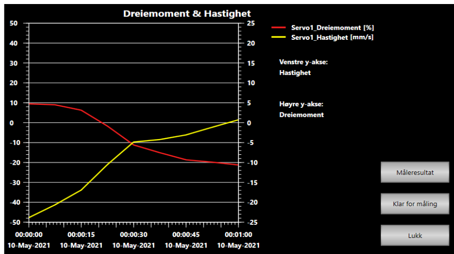
Figur 5.11: Under målesekvensen blir moment og hastighet logget i sanntid og presentert grafisk i HMI . HMI -skjermen vist i figuren er hentet fra Sysmac Studio og viser tilfeldige data.
