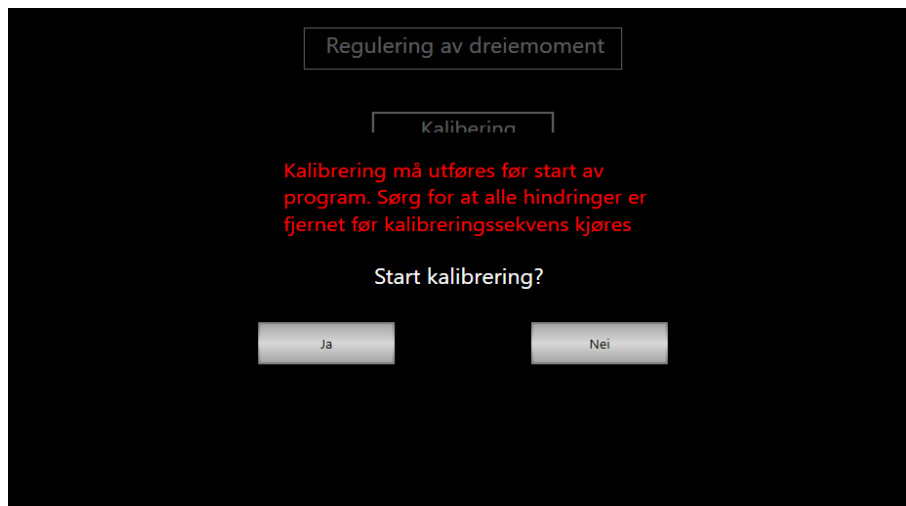
Figur 5.7: I figuren vises skjermen hvor bruker kan starte kalibreringsprosedyren for servomotor 1 og servomotor 2. Merk at dette er en popup -skjerm.
