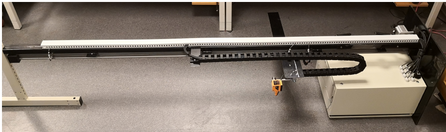
Figur 7.1: Figuren viser heismodellen lagt ned i horisontal retning. Til venstre i figuren (det som er øverste punkt når heismodellen står i vertikal retning) er det montert en fot som gjør at heismodellen står stødig i horisontal retning.
