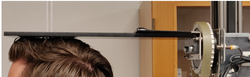
Figur 5.16: Bildet viser vinklingen til den svarte platen rett før den presser mot hodet til personen som skal måles.
