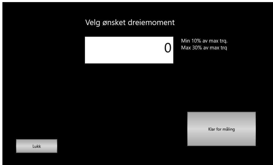
Figur 5.9: På skjermen vist i figuren spesifiserer bruker referansemoment som servomotor 1 skal bruke til å utføre høydemåling. Det er mulig å spesifisere moment i området [10, 30] % av maksimalt moment.
