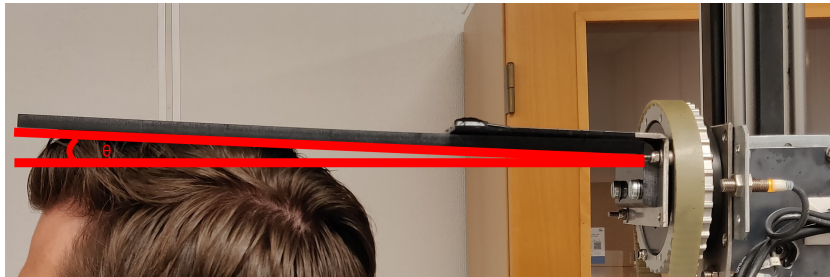
Figur 5.17: Bildet viser platenes vinkling etter at servomotor 1 har oppnådd et moment på -10%.
