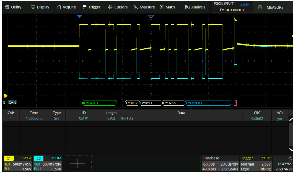
Figur 5.1.6: Skjerm bilde av CANbus-melding. (CH1: CAN:H, CH3: CAN:L)
