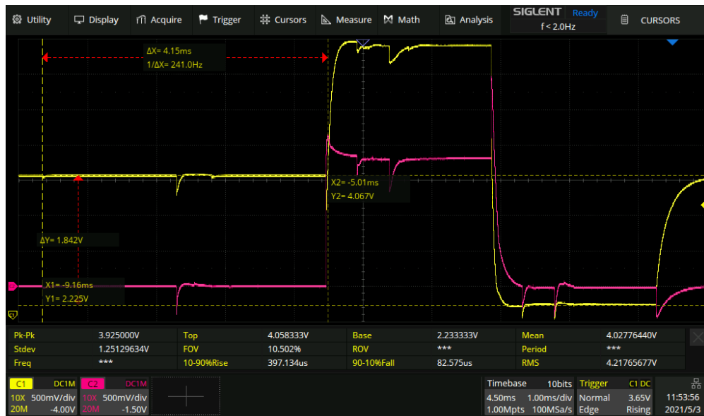
Figur 5.1.1: Skjerm bilde av måling av temperatursignal. (CH1: spenning over C9, CH2: spenning over temperatursensor)
