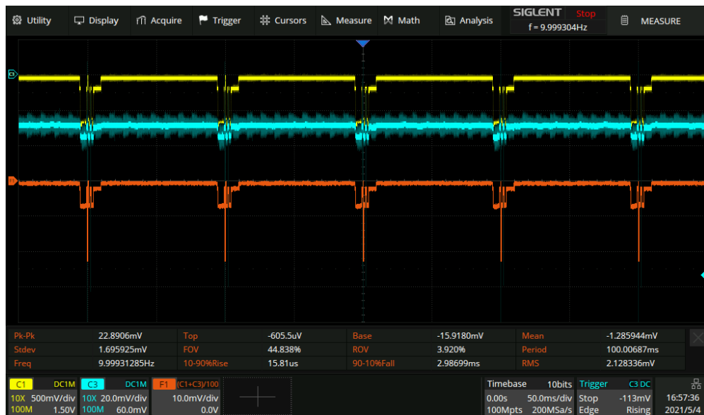
Figur 5.1.11: Skjerm bilde av spenning over R1, R2 og summen av disse på slavemodul. (CH1: spenning over R1, CH2: spenning over R2, F1: sum av spenningene)
