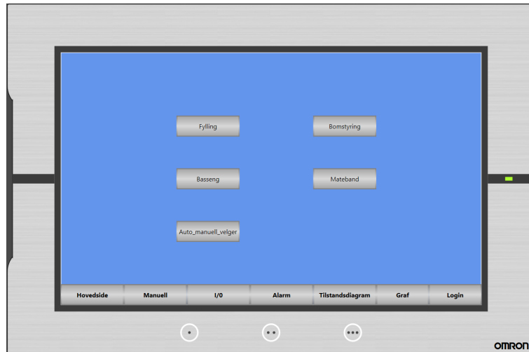
Figur 4.23: Tilstandsdiagrammsiden viser alle de ulike prosessene som skjer i programmet. Det er mulig å trykke inn på de forskjellige og få opp det relevante tilstandsdiagrammet, som vist for fylleprogrammet i figur 4.24.
