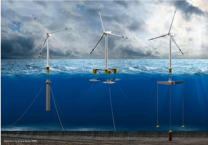
Figur 5 - Forskjellige typer flytere. Fra venstre Sparbøye, halvt nedsenkbar plattform (semi) og strekkstagsplattform. Illustrasjon av Joshua Bauer, NREL (Laurie, 2017).
