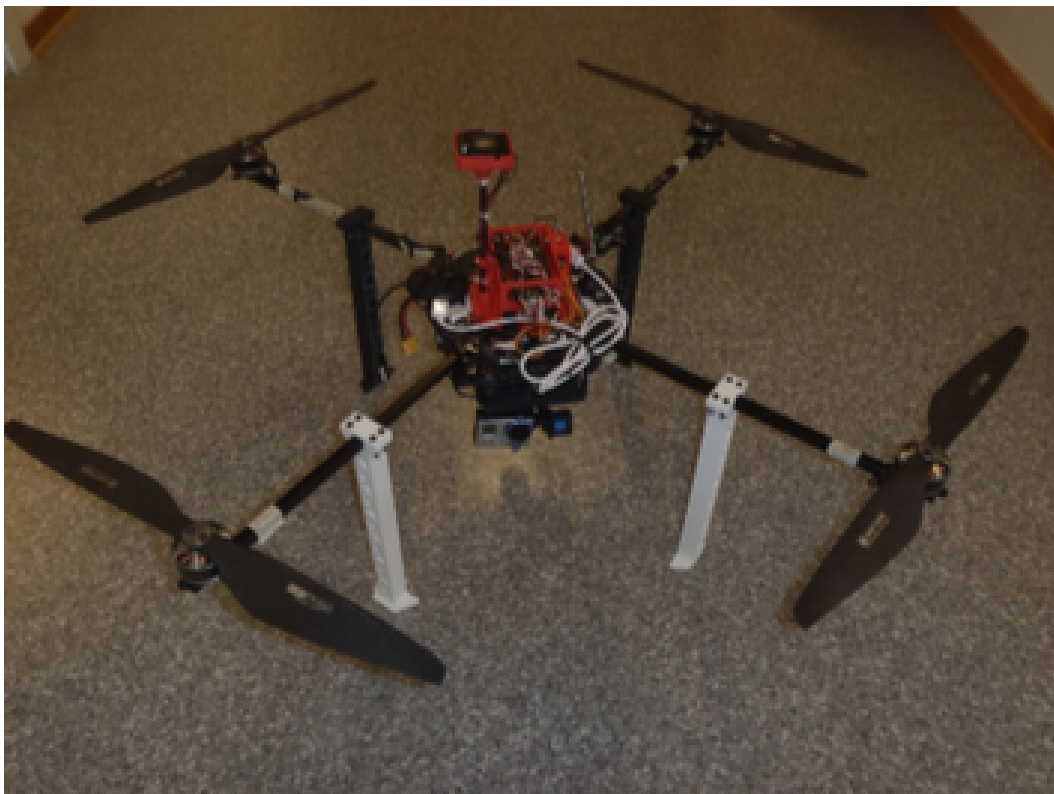
Figur 1: UAV brukt i denne oppgaven. Vekt er omtrent 2.5 kg og avstand fra motor til motor er omtrent 77 cm. Denne er utstyrt med en autopilot av typen ArduPilot. Flytid er estimert til 30 minutter.
