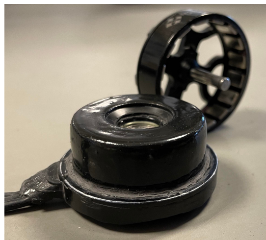
(b) Motoren etter innstøping.
