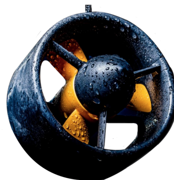
Figur 2.5: P1000 Thruster. Bildet er hentet fra [49]
