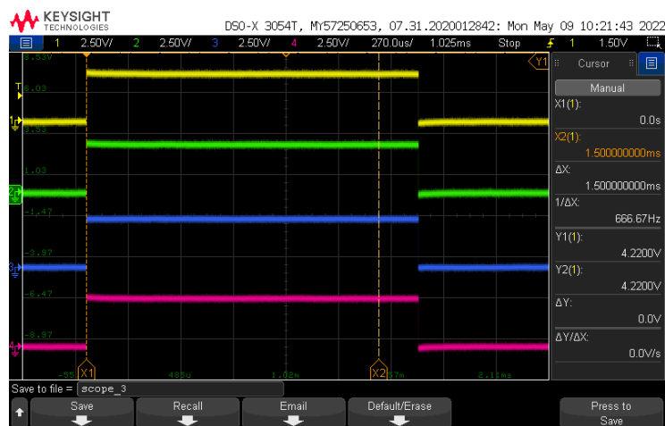
(a) PWM-signal ved kjøring nedover i hivretning. VHF(Gul), VHB(Grønn), VVB(Blå), VVF(Rosa).
