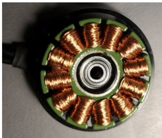
(a) Motoren før innstøping.
