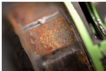
(b) Epoksyen er nedslitt, og statoren har begynt å ruste.
