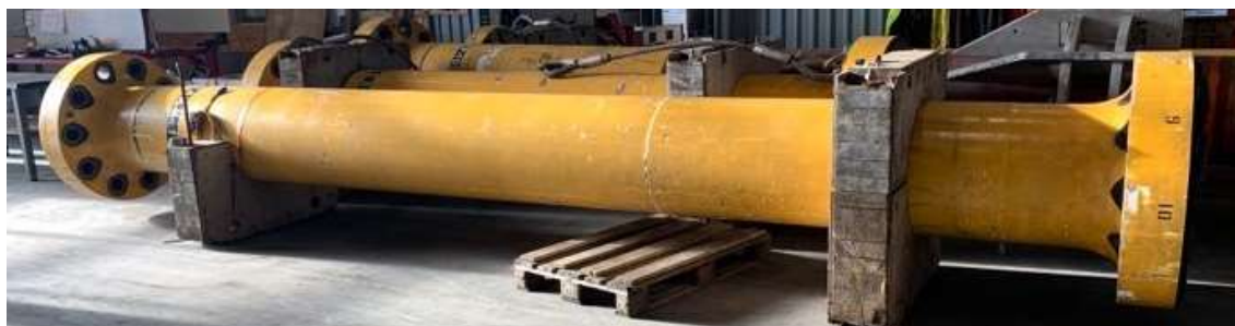
Figur 2 Standard HP riser 14.5 meter, fotografert januar 2022 hos WellPartner AS
