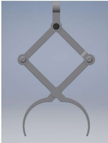
Figur 3: Konsept 1, Enkel klo som henges opp i kran, låser stigerør ved sin egen vekt. Krever bruk av 2 kraner og økt løftehøyde.
