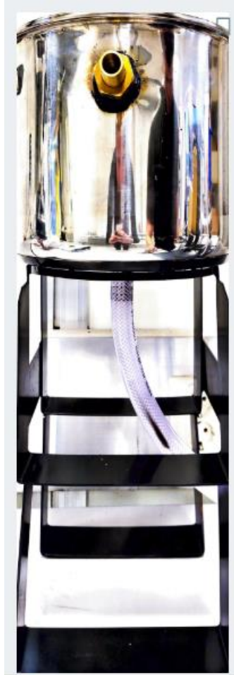
Figur 2.21.1-Tank til vaffelrøre, hvor slange fører røren fra tanken til pumpen, lokalisert rett til høyre for slangen i bildet.
