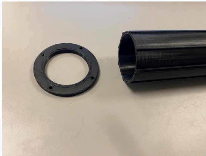
Figur 41 Skjærkraften fra gjengestangen klarte å sprekke det ene av de to leddene. Som man ser på bildet så er adskillelsen mellom de helt ren.
