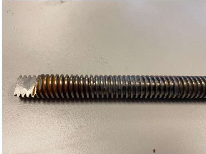
Figur 42 Rustoppsamlinger langs gjengestangen har antakelig påvirket friksjonen mellom gjengestang og gjengemutter.
