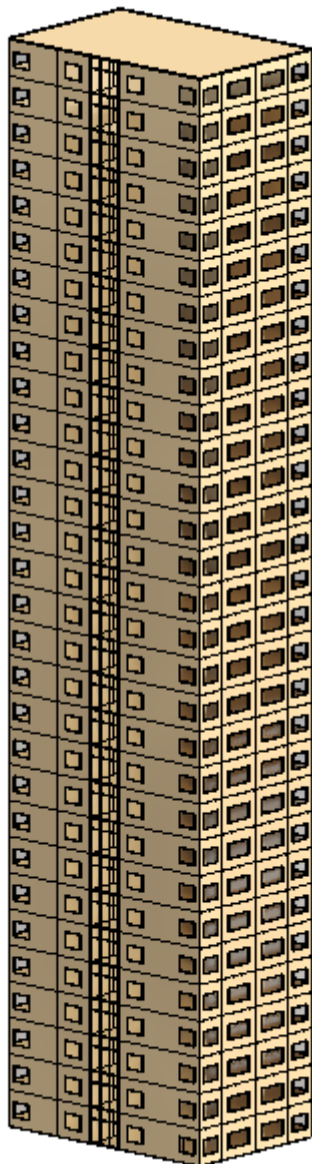
Figur 3 Modell av bygget konstruert i Revit.
