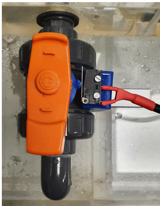
Figur B.8: Endebyrter tilhørende manuell ventil med 3D printet trigger.
