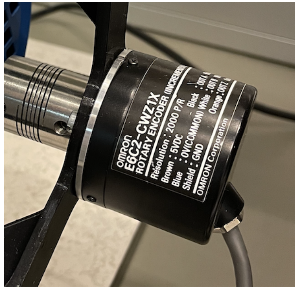
Figure 2.10: Enkoder: E6C2-CWZ1X fra Omron
