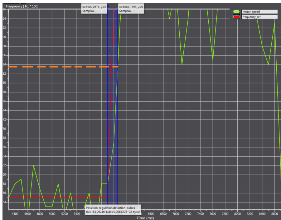
Figure 4.6: Endring av frekvensreferanse med frekvensomformerer satt i 'åpen krets'. Rød strek representerer frekvens referansen. Grønn strek; målt fart. Det blå tidsintervallet markerer tiden det tar å oppnå \tau . Oransje stiplede strek markerer den målte hastigheten ved \tau . X-aksen er i millisekund og Y-aksen i skalert verdi for Hz (100 = 1Hz).
