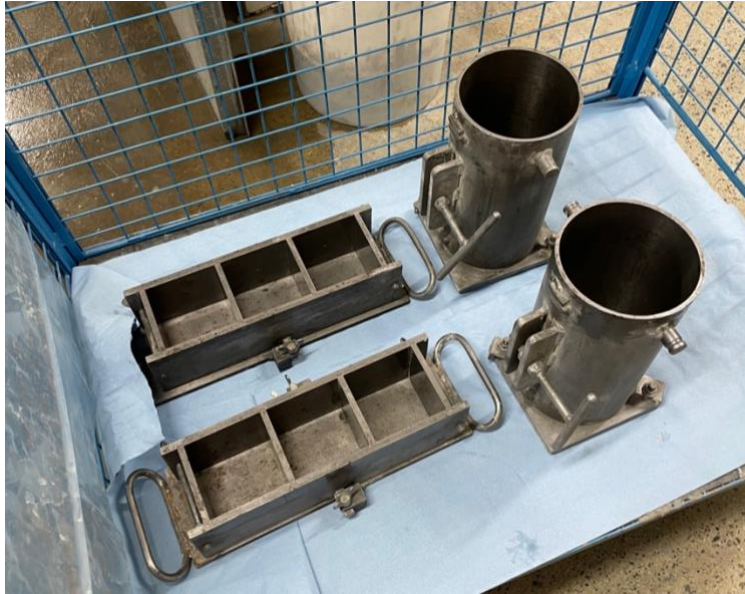
Figur 5 – Terning og sylindrerformer
