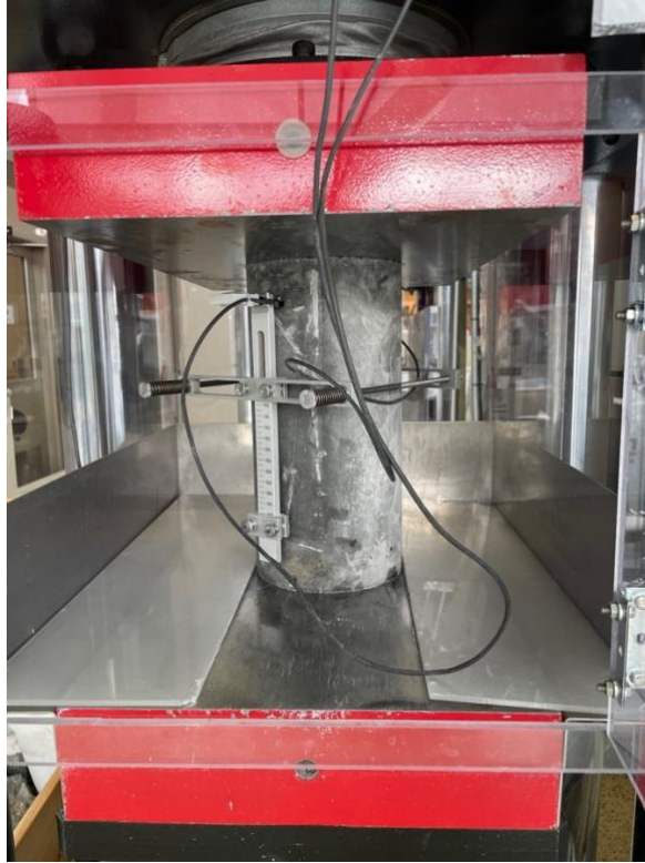
Figur 8 – E-modul av sylinder
