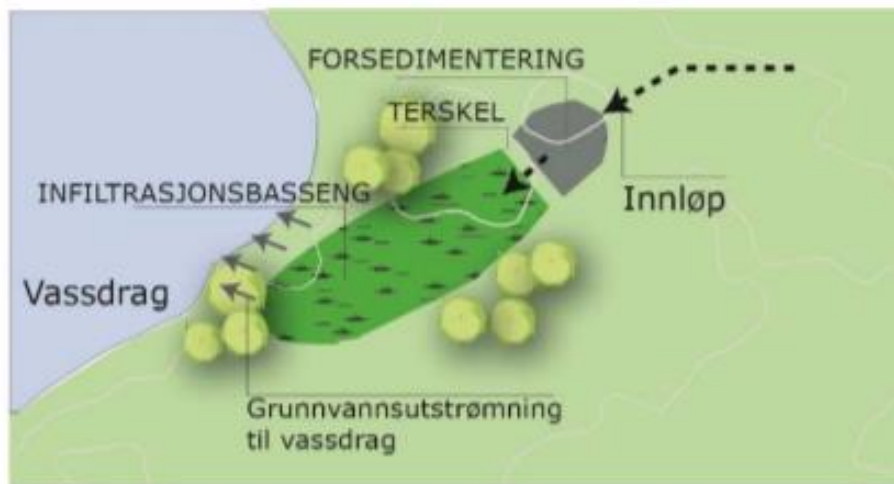
Figur(14) (Tønsberg kommune, 2022), infiltrasjonsbasseng
