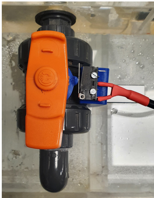
Figur B.8: Ende bryter tilhørende manuell ventil med 3D printet trigger.
