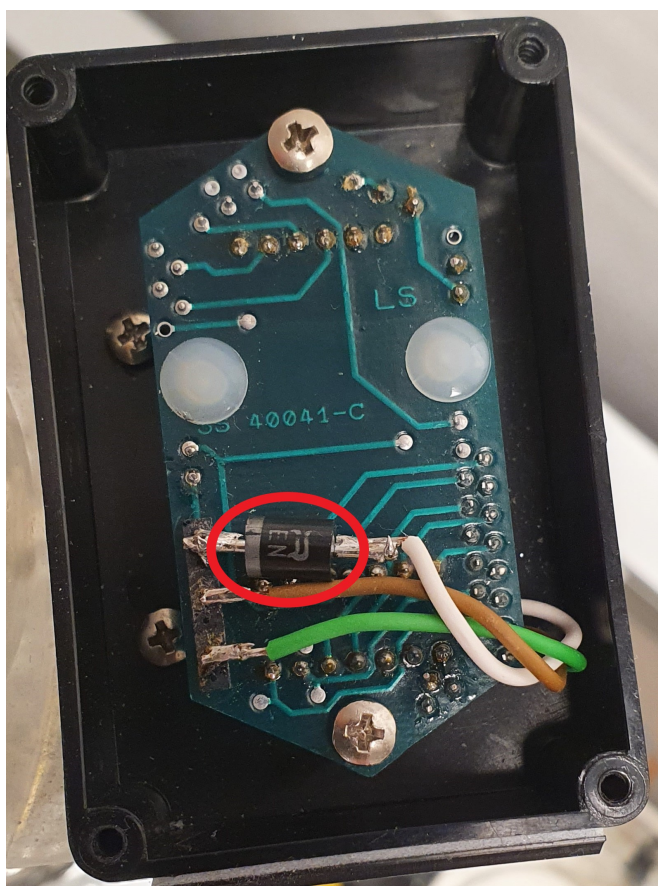
Figur B.17: Bilde viser oversiden av kretskortet til DP cellen med diode (rød sirkel) tilkoblet mellom hvit leder og V_+ .
